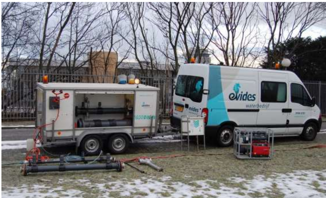
Figuur 2 Overzicht van mogelijke hulpapparatuur voor desinfectie van het leidingnet.
