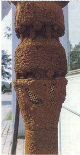
Foto 1. Ijzeraanslag op pomp (foto WLN)
