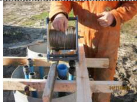
Foto 20. Opmeten diepte (foto Brabant Water)
